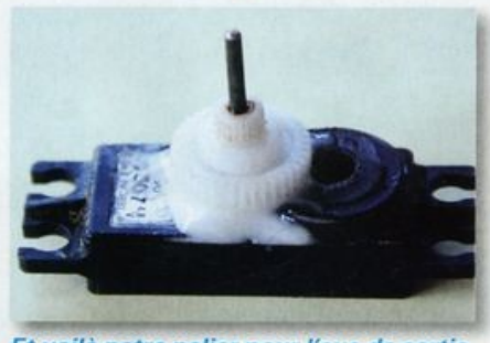
Et voilà notre palier pour l'axe de sortie, collé sur le boîtier.
