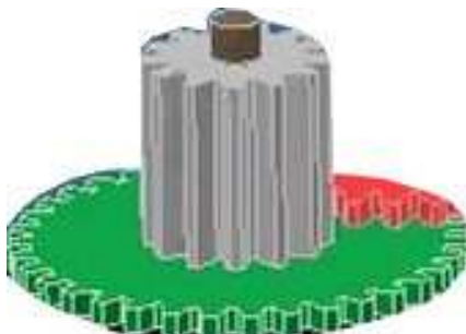
Etape 3 : Création du troisième engrenage et de l'axe engrenage 3
